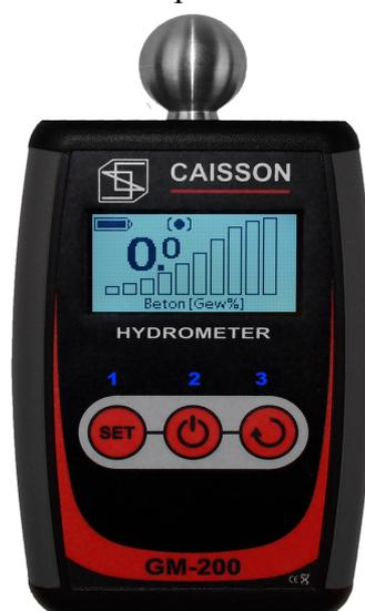
**GM-200 im Menü-Modus.** 1 - Die Wahl des früheren Menüpunktes oder Verminderung des Wertes; 2 - Die Bestätigung der gewählten Option oder des gewählten Wertes; 3 - Übergang zum weiteren Menü-Punkt oder Erhöhung des Wertes.
