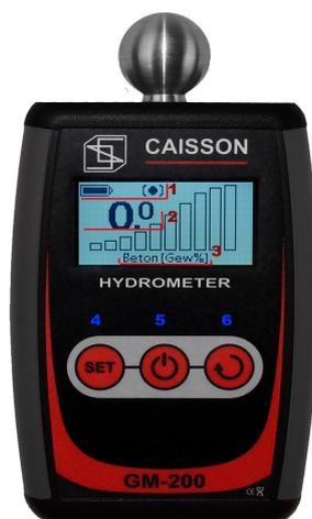
1 - Statusleiste; 2 - Messwert; 3 - Bezeichnung der ausgewählten Skala; 4 - 'SELECT MATERIAL'-Taste; 5 - 'ON'-Taste; 6 - 'SELECT DISPLAY'-Taste.
