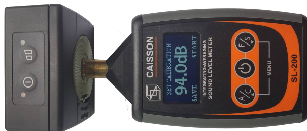
Bild 3.1 Der akustische Kalibrator auf Ihren Schallpegelmesser gesetzt
