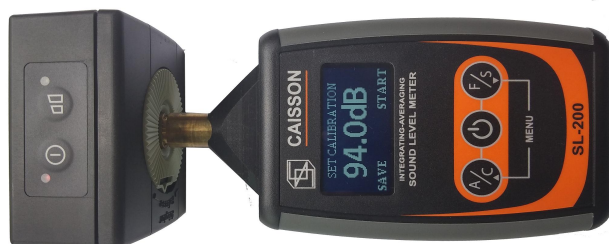
fig.3.1 Geluidsdruk kalibrator verbonden met de geluidsdrukmeter.
